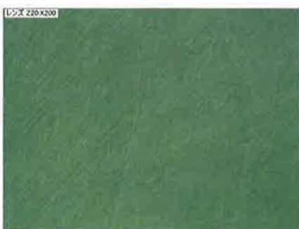
図8 ジルコニアブロックにハンドスケーラーを 10 秒間ストローク (同 200 倍像). 変化みられず
