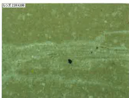
図6 長石系ブロックに超音波スケーラーで 10 秒間ストローク (同 200 倍像). 表面が抉れている
