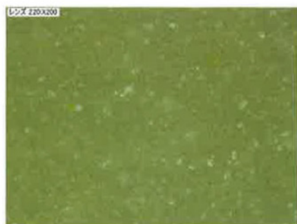
図4 長石系ブロックにレギュラーペーストをつけたブラシで 10 秒間研磨 (同 200 倍像). 傷がみられた
