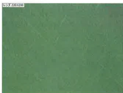
図9 ジルコニアブロックにレギュラーペーストをつけたブラシで 10 秒間研磨 (同 200 倍像) わずかな傷がみられた
