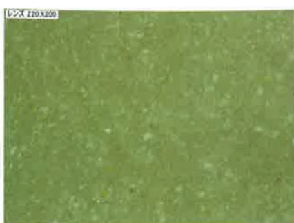
図2 長石系ブロックにハンドスケーラーで 10 秒間ストローク (同 200 倍像). 変化みられず
