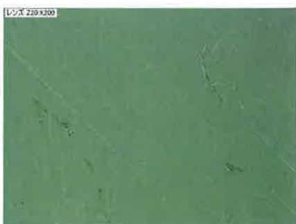
図11 ジルコニアブロックに超音波スケーラーで 10 秒間ストローク (同 200 倍像). 表面が抉れている
