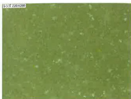
図3 長石系ブロックにファインペーストをつけたブラシで 10 秒間研磨 (同 200 倍像). 変化みられず
