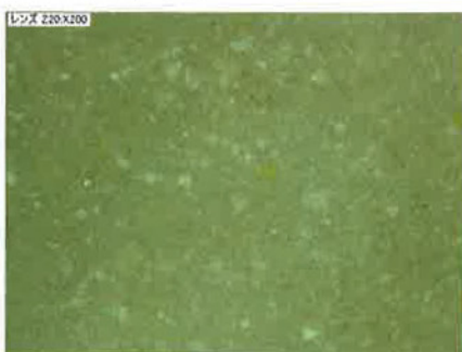
図5 長石系ブロックにエアフローを 10 秒間噴射 (同 200 倍像). 曇ったような変化がみられた
