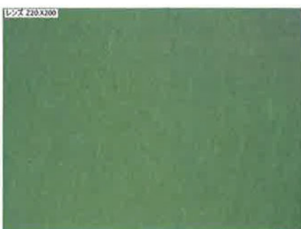
図10 ジルコニアブロックにエアフローを 10 秒間噴射 (同 200 倍像). 変化みられず
